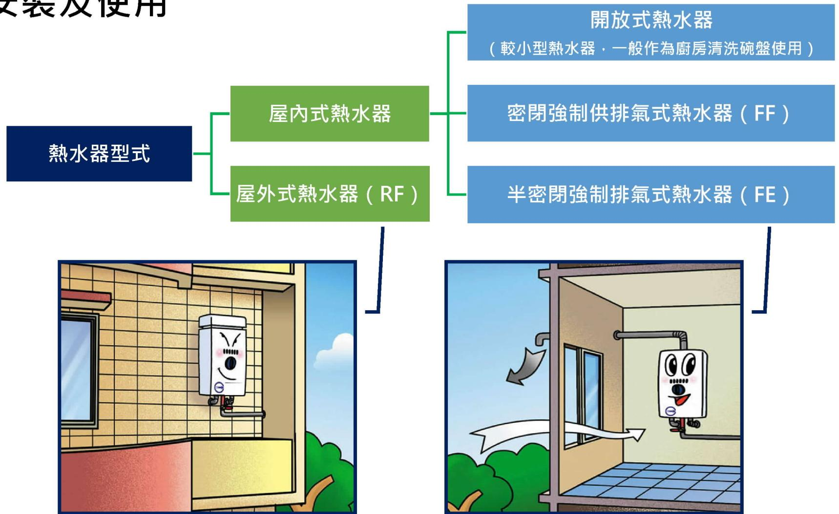
請檢視居家燃氣熱水器，如有將屋外式熱水器（RF）安裝在有加裝窗戶的陽臺或屋內等通風不良場所，即有一氧化碳中毒危險，應委託「合格」承裝業技術士將熱水器遷移至屋外或更換為強制排氣式熱水器、電熱水器、太陽能熱水器，以維護生命安全。
